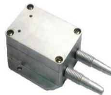
风管压差传感器：将过滤网前后压差转化为电信号，通过电信号的大小判定压差值，从而判断过滤网是否需要清洗
