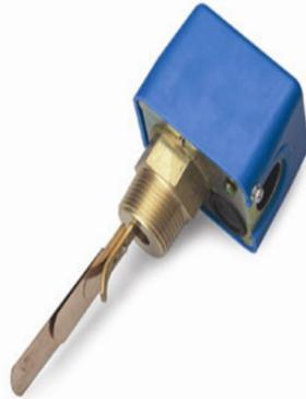
水流开关：当有水流流动时，水流开关内的磁芯受水流推动产生位移，磁芯位移带动磁源产生磁控作用使水流开关输出信号
